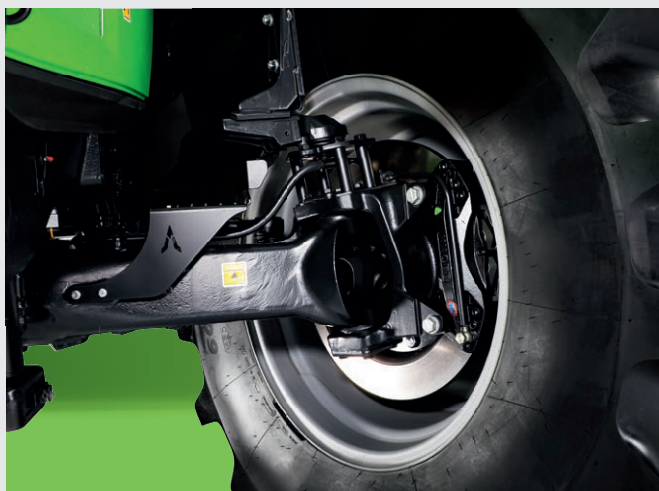
Travões de disco secos para o máximo desempenho da travagem.
