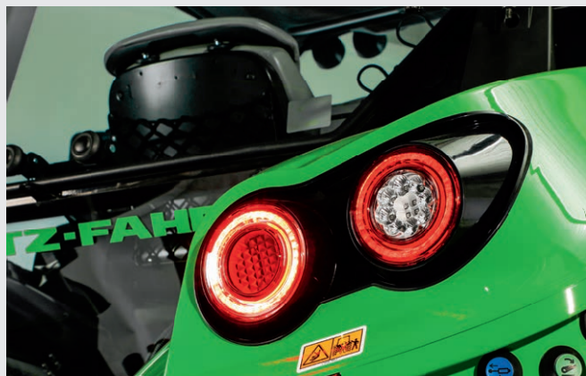
O indicador de mudança de direção LED oferece mais segurança e um aspeto mais agradável e moderno.
