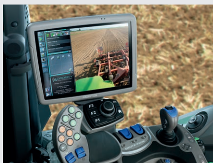
↑ Câmara integrada com modo de ecrã inteiro automático (por exemplo, marcha-atrás), para uma perspetiva mais nítida e segura.
