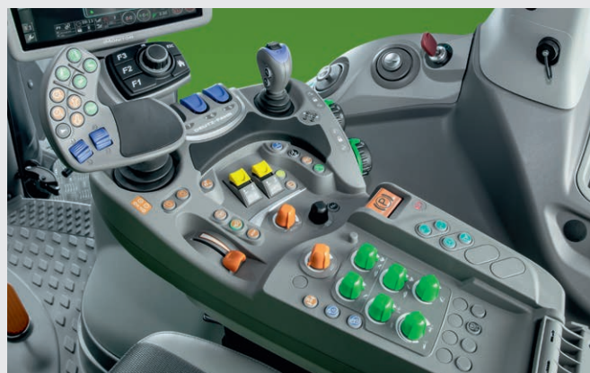
↑ Disposição DEUTZ-FAHR comprovada. Funções agrupadas por cores para uma utilização intuitiva.
