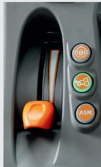
↑ 4RM, bloqueio dos diferenciais e ASM com comando eletro-hidráulico.
