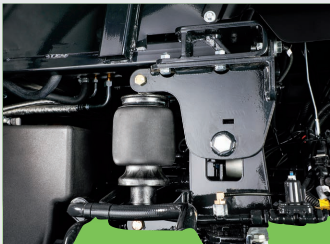
Suspensão pneumática da cabina para uma condução suave.
