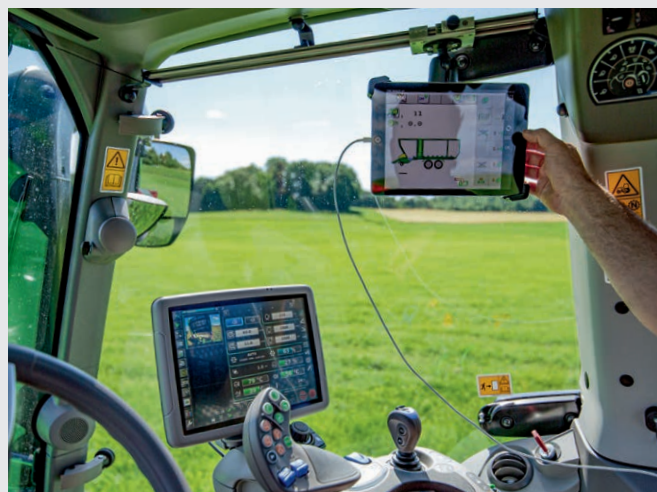
↑ Suporte de fixação disponível para monitores externos.
