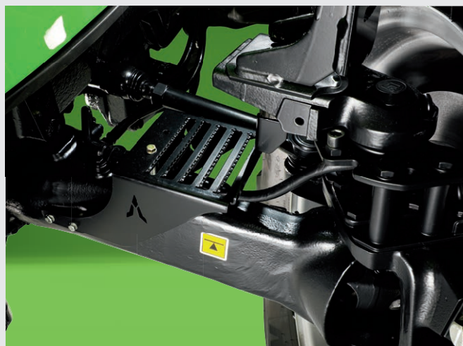
Degraus de manutenção sobre o eixo dianteiro para uma limpeza confortável.
