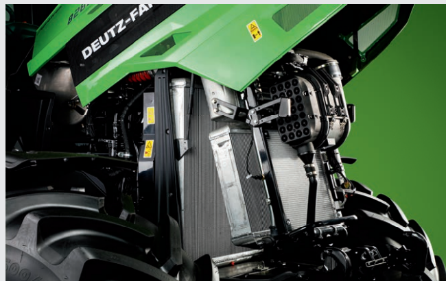
↑ Fácil acesso ao radiador e ao filtro de ar.
