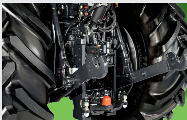
↑ Braços inferiores com posição de transporte.
