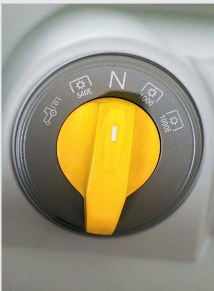
↑ TDF com comando eletro-hidráulico.
